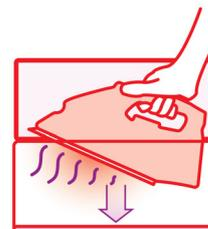
Термоизолированный короб предназначен для удобного хранения горячего утюга. Для продления срока службы короба, прежде чем помещать утюг в короб, отсоединяйте его от электросети и сливайте воду из резервуара. Нижняя часть короба при этом может нагреваться, однако риск повреждения отсутствует.
